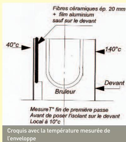
**Résultat :** l'enveloppe acier de l'alambic chauffe 3 fois moins pendant une distillation. Par l'isolation, nous estimons une économie d'environ 30% de propane sur notre installation. Il semble intéressant d'isoler aussi le dessus du bain-marie.
